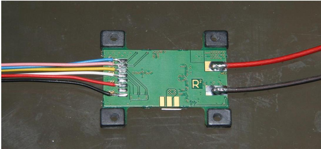
Die Servo-Stecker werden flach aufgesteckt, Masse in der Mitte, Signal außen. Die Kanal Belegung ist korrespondierend mit der Unterseite aufgedruckt:
