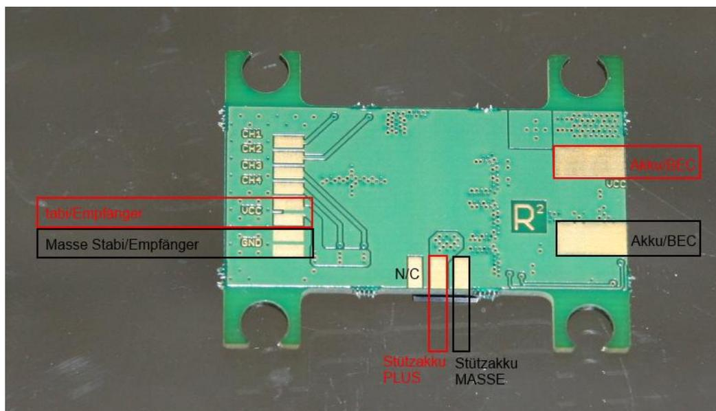
Die Versorgungs- und Sinalleitungen werden auf der Unterseite des PowerBUSmini angelötet.
